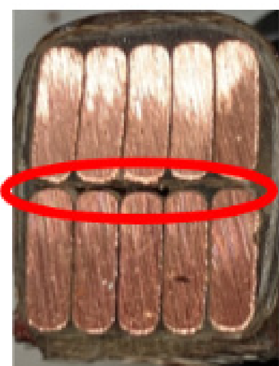
固定乾燥の コイル断面
