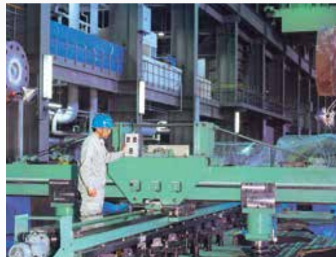
タービンケーシング現地機械加工
