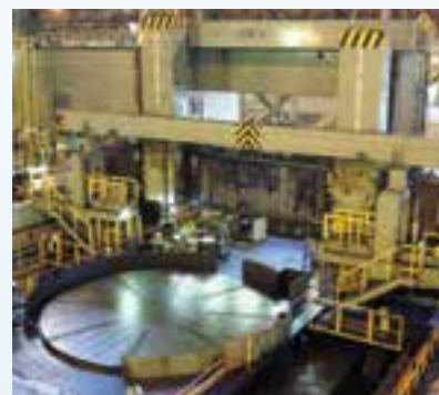
超大型ターンミラー (最大加工寸法φ9000X5000)
