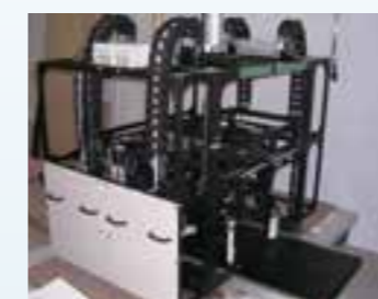
平判紙山外観検査装置 (紙ハルプ技術協会2014年佐々木賞受賞)
