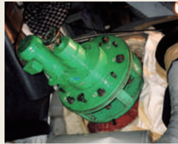
当社考案、製作フランジ加工機加工径：φ800~φ2000mmに対応4種類、6台保有
