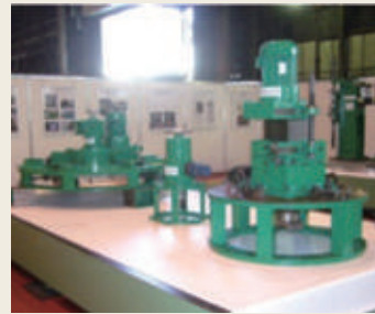
当社考案、製作フランジ加工機加工径：φ300~φ1000mmに対応 特殊形状フランジに対応
