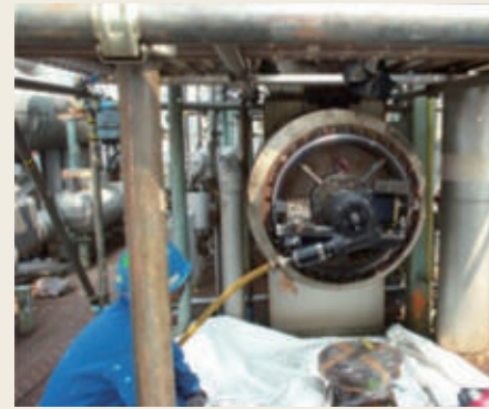
駆動源：エアモーター 1.55HP (1.2kW) 加工径：φ155~φ760mmに対応
