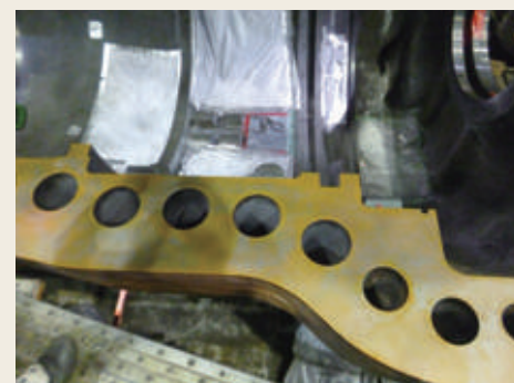
加工後上下継ぎ手面当り確認
