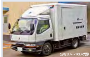
絶縁診断車(現地) 診断機器、試験電源、100mの測定ケーブルを搭載(オフライン)
