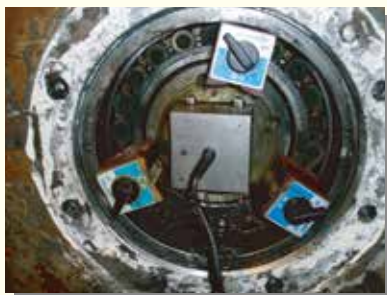
2 軸端面へプローブセット
