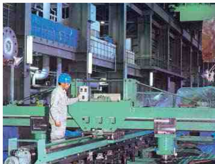
タービンケーシング現地機械加工
