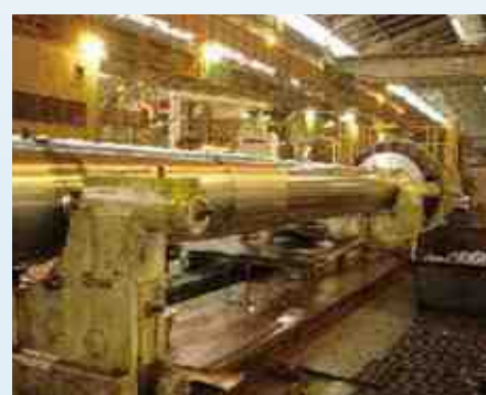
大径軸加工(大型旋盤)
