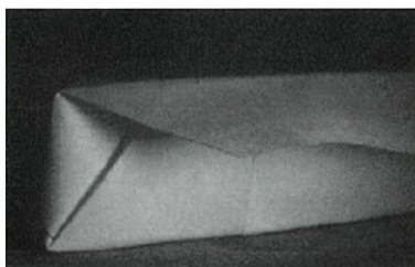
のり付け不良
