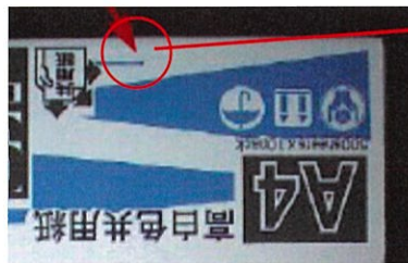
印刷柄の不良ロット 高精度検出例
