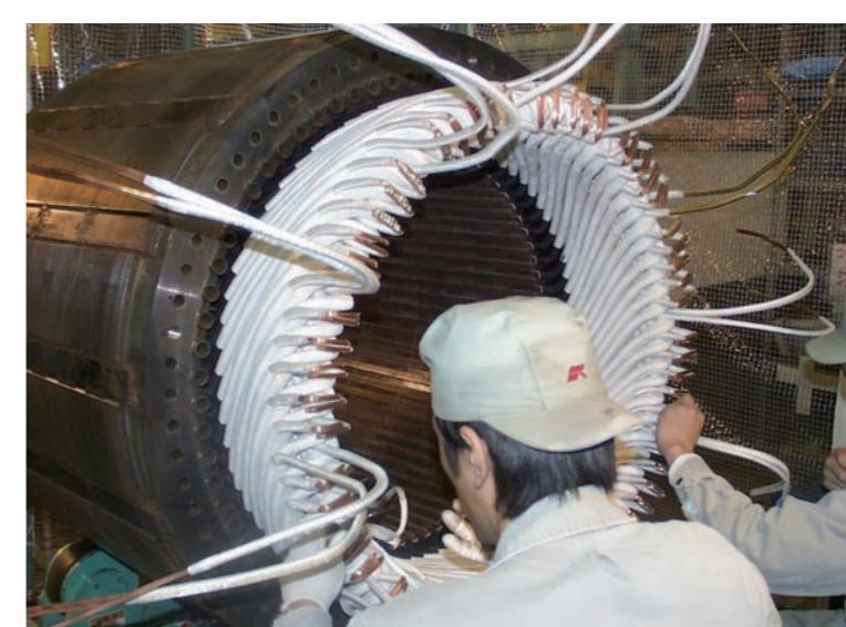
補修完了後のモータ
