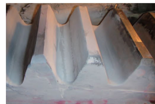
最終確認(亀裂・寸法)
