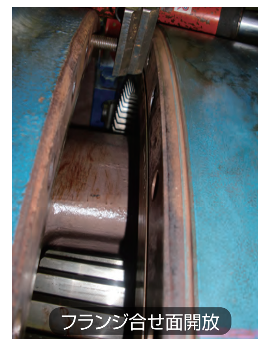
増速機フランジ部ボルトピン折損補修(取替)
