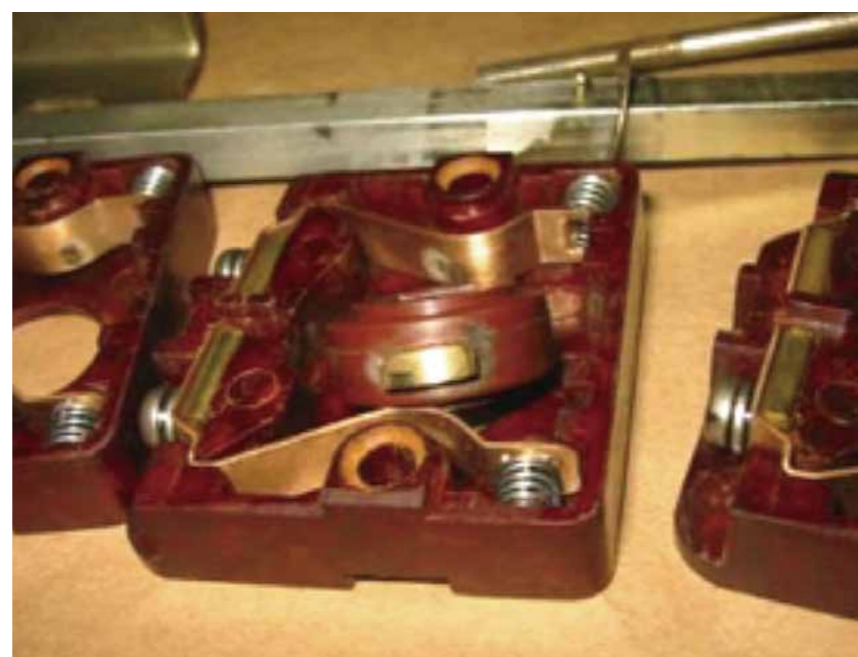
分解し内部固定・可動接点の荒損・摩耗の確認
