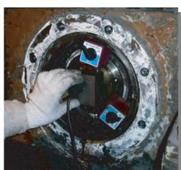
軸端面にプローブをセットするだけで軸内部の疲労割れの**有無**とその**位置**(長手方向位置、角度方向位置)を調べる事が出来ます。
