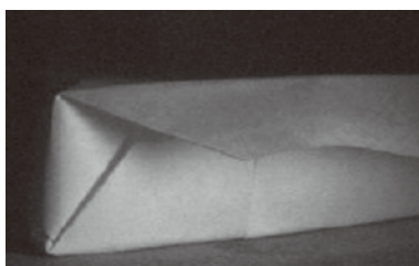
のり付け不良
