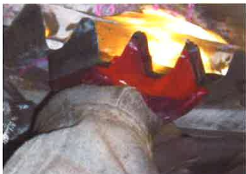
機内での旋回ギヤー成型仕上げ作業
