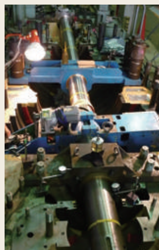
ケーシングボーリング加工
