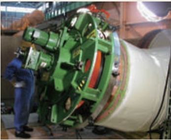
駆動源：エアモーター 0.79HP (0.59kW) 加工径：φ47～φ305mm
