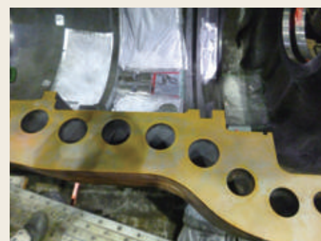
加工後上下継ぎ手面当り確認
